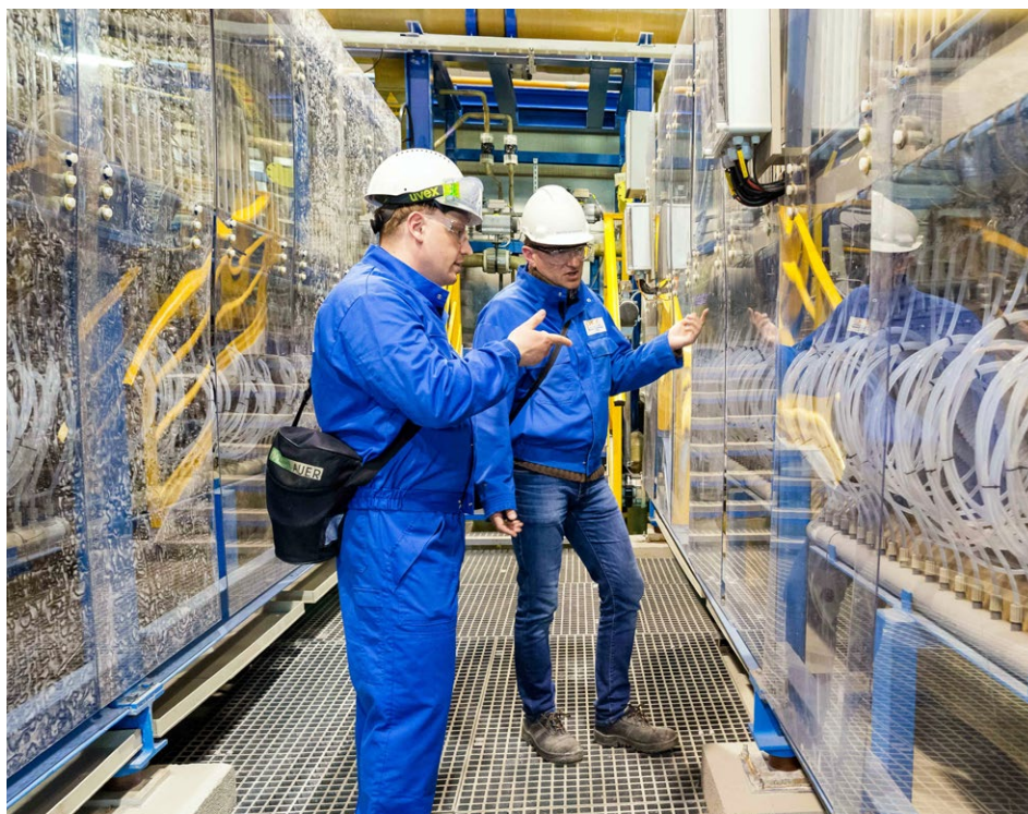
Instalacja elektrolizy membranowej jednostki biznesowej chloru spółki PCC Rokita SA w polskim zakładzie produkcyjnym w Brzegu Dolnym: Już dawno, bo w 2015 roku, przestawiliśmy całą naszą produkcję chloru na przyjazną dla środowiska i energooszczędną technologię membranową, która jest obecnie obowiązkowa w UE.
